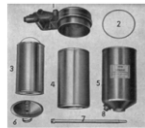
۱- پایه فیلتر روغن ۲- واشر ۳- صافی بای پس ۴- فیلتر کامل ۵- کاسه فیلتر ۶- بشقاب فنری ۷- پیچ مرکزی ۸- پیچ تخلیه روغن
